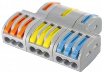
Jonction rapide à levier 3 pôles pour joindre rapidement trois câbles électriques à 9 conducteurs (3 conducteurs par pôle). dimensions : 40mm x 52mm x 15mm - Tension : 230 V max - Courant : 32 A max.
