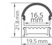
**Profilé pour bandeau LED, en aluminium.** Diffuseur lacté arrondi. 21,8 mm x 19,5 mm – Possibilité d'installer un ruban jusqu'à 16,5 mm de largeur.
