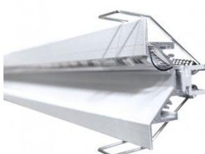
**Profilé aluminium de corniche encastrable pour ruban LED.** Finition blanc laqué. 53 mm x 15 mm (53 x 33 mm avec les clips de fixation) – Pour ruban LED jusqu'à 10mm de largeur.
